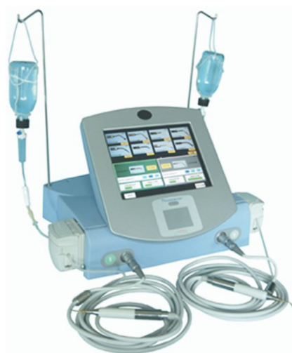
Rycina 2. The Piezosurgery Medical Device (PMD; Mectron Medical Technology, Carasco, Włochy) – prototypowe urządzenie piezochirurgiczne, wykorzystane w 2004 r. przez Robiony do przeprowadzenia pierwszej rinoplastyki z wykorzystaniem urządzenia piezoelektrycznego [12].
