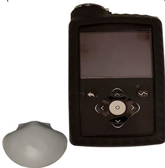
Rycina 2. Pompa insulinowa MiniMed 670G i Guardian 3 CGM [1]
