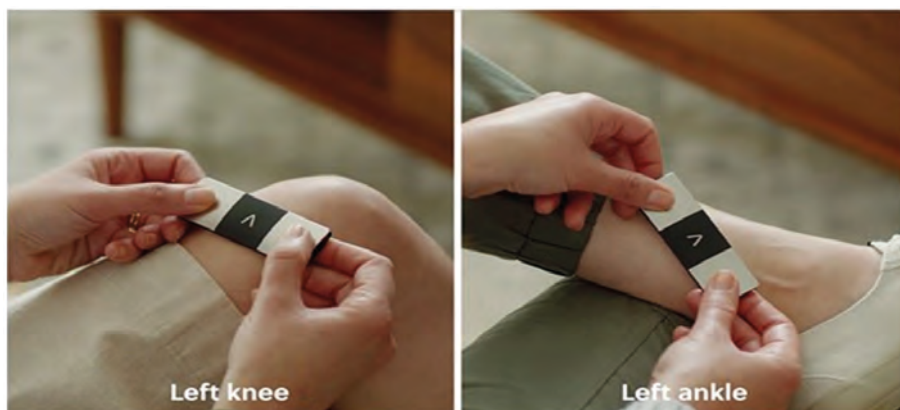
Rycina 4. Proponowane przez producenta przyłożenie elektrod podczas przeprowadzania 6'cio odprowadzeniowego EKG przy użyciu KardiaMobile 6L [11]
