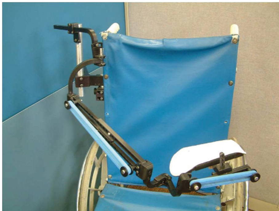
Rycina 1. Orteza WREX przymocowaną do wózka inwalidzkiego [3]
