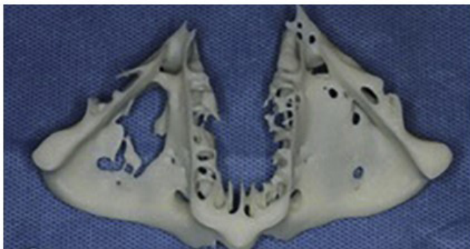
Zdjęcie 4. Model z defektem prawego oczodołu, wykonany techniką druku trójwymiarowego z wykorzystaniem technologii FDM 25 .
