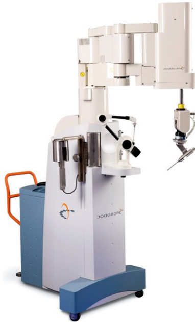
Rycina 1. Na rycinie przedstawiono robota chirurgicznego THINK Surgical TSolution-One® [15].
